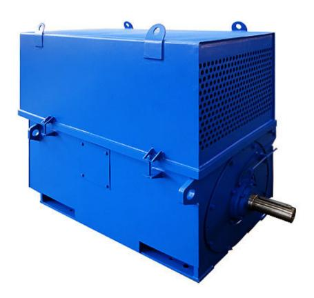
Высоковольтные двигатели ENERAL рассчитаны на работу от сети переменного тока частотой 50Гц напряжением 6000В. Пуск двигателей прямой, допустимы два пуска подряд из холодного состояния или один пуск из горячего состояния. Двигатели имеют правое и левое вращение, изменение направления вращения осуществляется из состояния покоя.
