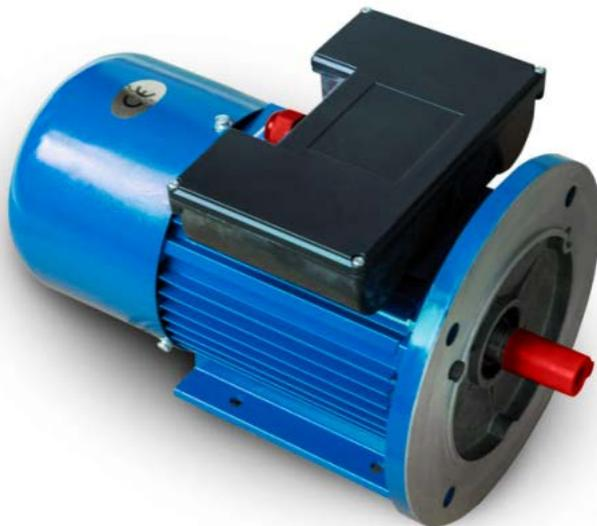
Однофазные электродвигатели с пусковым и рабочим конденсаторами предназначены для работы в составе агрегатов, требующих большего пускового механизма. Подключение пускового конденсатора параллельно с рабочим только на старте дает возможность увеличить пусковой момент. Емкость пускового конденсатора определяется необходимым пусковым моментом.
