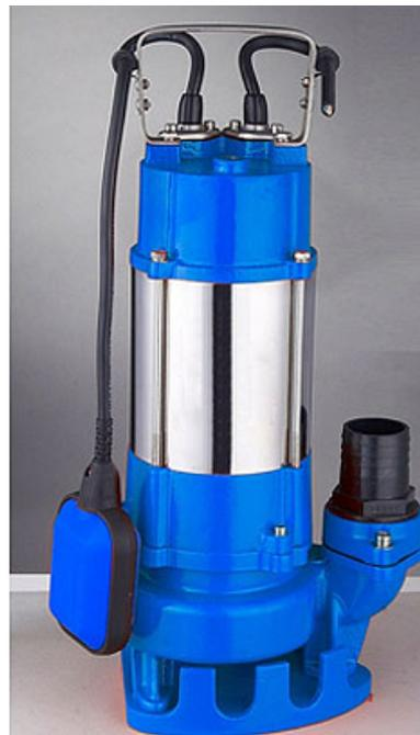
Электронасосы переносные погружные моноблочные центробежные типа ГНОМ предназначены для откачивания загрязненных вод с температурой 35°C ( в моделях Тр до 60°C) с рН 5-10 плотностью до 1200 кг/м при содержании твердых механических примесей до 10% по массе с плотностью твердых частиц не более 2500 кг/м и максимальным размером до 5 мм. Время работы электронасоса на «сухую» или в полупогруженном состоянии не более 15 минут.
