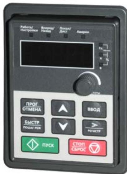
Выносная (внешняя) панель управления используется для обмена информацией между пользователем и преобразователем частоты:
